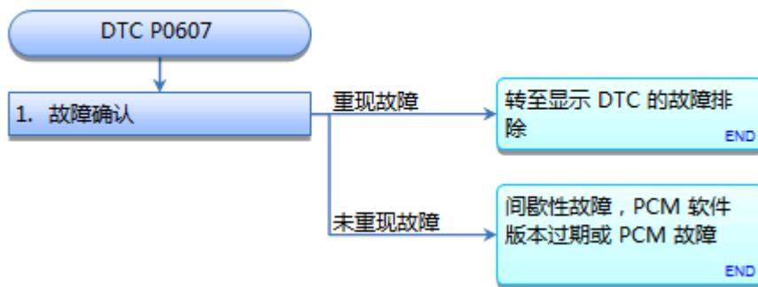
**DTC P0607: PCM 内部电路故障**
